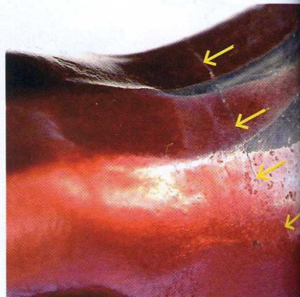
À gauche, une étude du DHV, la fédération allemande, montrant les variations de charge dans un mousqueton - donc induisant des micro-mouvements - en vol thermique puis en spirale. Au centre, les concentrations de contraintes. Et à droite, les micro-fissures dans le mousqueton « survivant » de l'incident slovaque, page précédente (celui qui n'a pas cassé).
